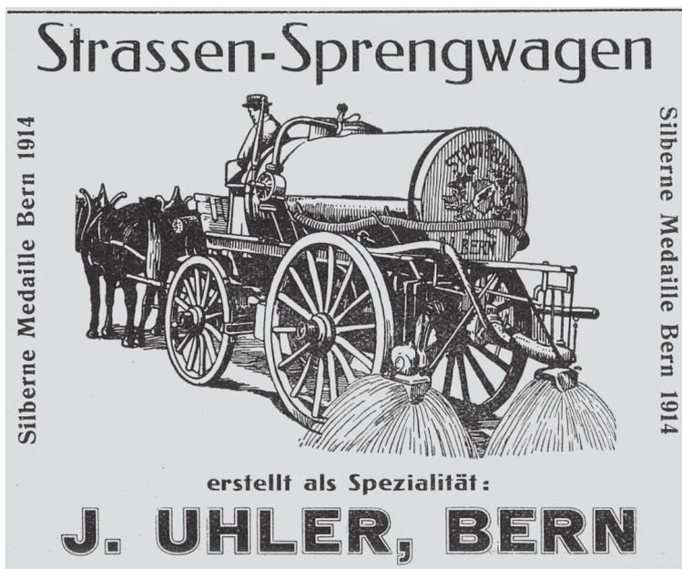
Abb. 26: Inserat aus der Schweizerischen Zeitschrift für Strassenwesen aus dem Jahr 1920. Die Besprengung der Schotterstrassen mit Wasser oder auch mit Wasserglas (flüssiges Kalium- oder Natriumsilikat als Bindemittel) war bis nach dem Ersten Weltkrieg eine der hauptsächlichlichen Massnahmen gegen den Strassenstaub. Das in Bern fabrizierte Modell wurde an der Landesausstellung von 1914 prämiert.
