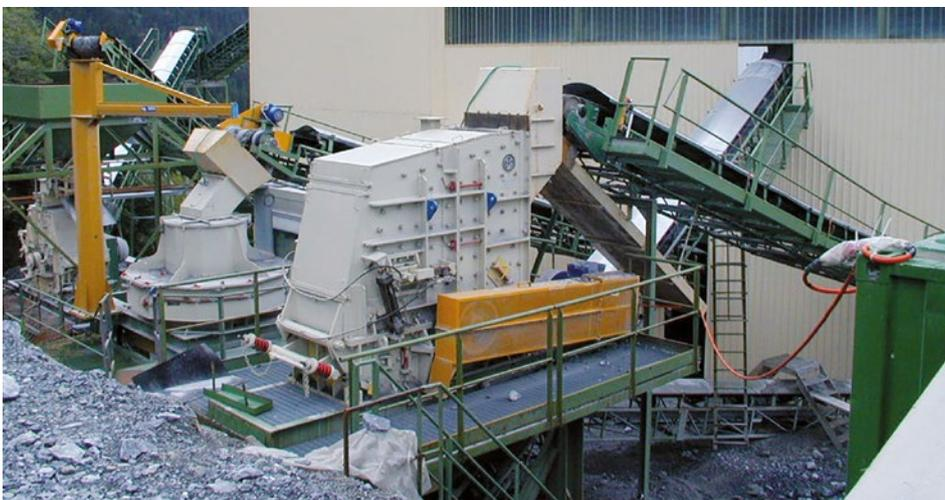
Weitgehend automatisierte Aufbereitung des Tunnel-ausbruchmaterials zu Strassenkoffer und Beton-zuschlagsstoffen beim Bau der Umfahrung Flims im Jahr 2001. (Tiefbauamt Graubünden)
